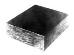
Blocos de neoprene e tecido de algodão. 64 camadas por polegada de espessura. Capacidade de carga de até 703 kg/cm<sup>2.</sup> Capacidade de carga de choque de até 140 kg/cm<sup>2.</sup> Resistente a faixa de temperatura de -37 °C até 93 °C.
