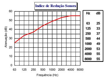
**Nota1:** A porta 56dB pode ser utilizada como porta hermética, na construção com soleira saliente, sendo apta a uso em casas de máquinas ou plenuns de ar condicionado, resistindo a diferença de pressão positiva ou negativa de até 80 mmca.
